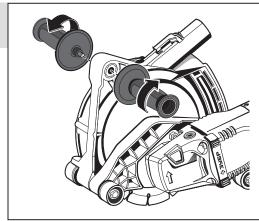
3. Регулировка положения основной рукоятки
